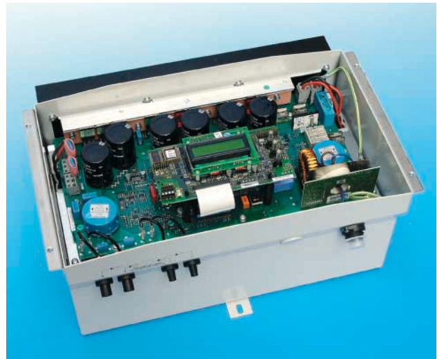
Bild 2 Innenansicht Sunny Boy von SMA
