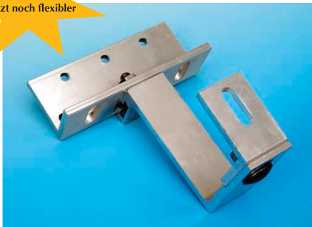
Bild 15 Der neue Sparrenanker F ist sehr flexibel. Er kann für unterschiedliche Dachlattenstärken verwendet werden, kann Dachunebenheiten ausgleichen und bietet schließlich ein Langloch zur flexiblen Anordnung der Montageschiene. Kräftige Querschnitte sorgen für ein Plus an statischer Sicherheit.
