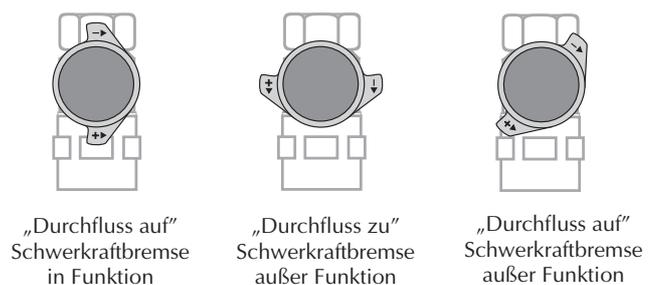
Bild 7 Die drei Funktionen der Kugelhähne in der CIRCO 5
