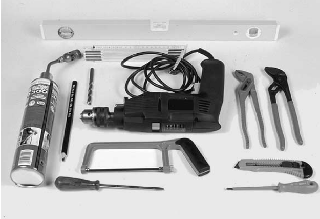
Bild 5 Montagewerkzeug: Bleistift, Zollstock, Wasserwaage, Bohrmaschine, 8/10/12er Steinbohrer, 2 Rohrzanzen, Lötbrenner, kl./gr. Schraubendreher, Säge, Messer
