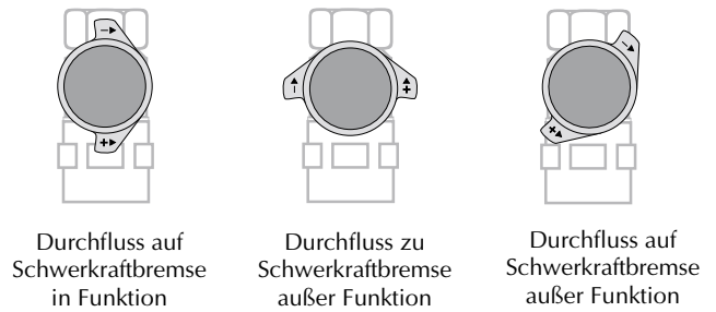
Bild 3 Die drei Funktionen der Kugelhähne in der Solarkreisstation
