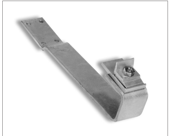
Abb. 26 Dachanker BS Stv KF Top für Schiefer- und Biberschwanddächer zum Ausgleich von Dachunebenheiten (Grundset 6 Stück Art.-Nr. 192 030 25).
