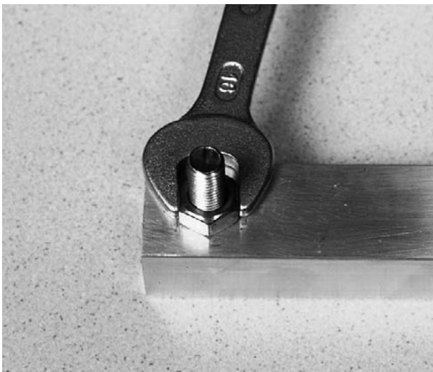
Bild 15 Achten Sie bitte beim Festziehen der Schrauben darauf, dass die Flanke der Mutter rechtwinklig zur Längsseite der Schiene sitzt. Wichtig für Passgenauigkeit des Kollektors!
