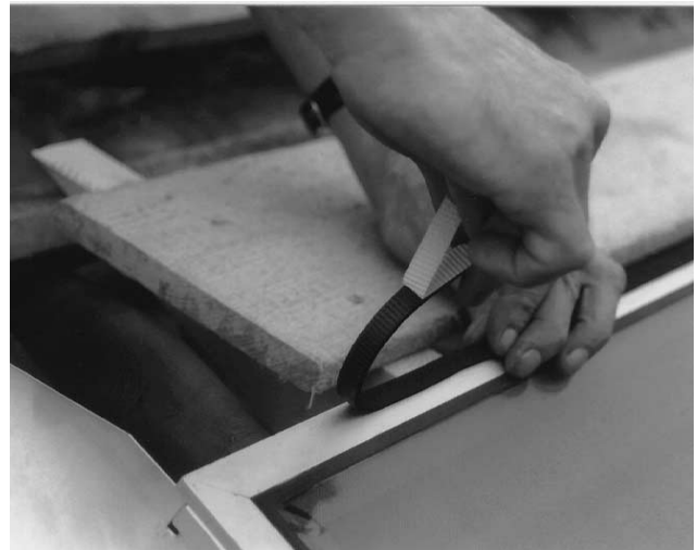
Bild 30 Auf den Kollektorrahmen oben dünnes Zellgummiband kleben.
