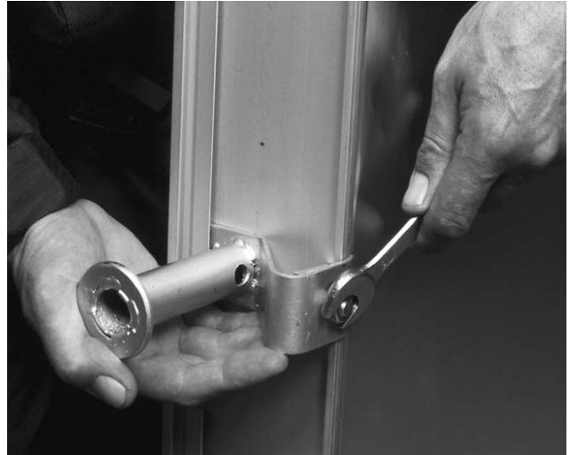
Bild 12 Tragegriffe liefern wir auf Wunsch. An beiden Seiten des Kollektors mit Befestigungsklemme - höheren Absatz zum Kollektor - festschrauben. Sicherem Halt überprüfen!
