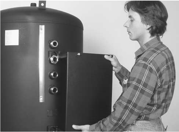
Bild 18 Option "Anbausatz RATIO-H": Dämmung entfernen, Montageplatte an dem zweiten und fünften Anschluss von oben einhängen.
