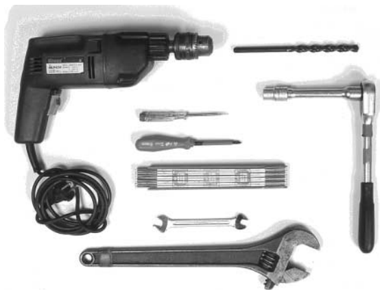
Bild 4 Sie benötigen folgendes Werkzeug: Bohrmaschine, Steinbohrer (12mm), Spannungsprüfer, Schraubendreher, Gliedermaßstab, 10er Maulschlüssel, Rollgabelschlüssel, Ratsche mit 13er Nuss
